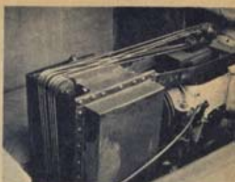
Växellådan vållade en del problem genom placeringen bak. Växelfärrarna fick konstrueras om. Hembyggd överväxel minskar bensinåtgången.
